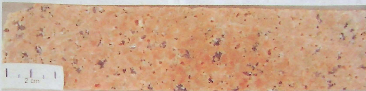
Foto 7 – Fácies B do granito Passa Três, com cavidades por dissolução hidrotermal e com fraturas parcialmente preenchidas por fluorita, carbonatos, quartzo e sulfetos.
